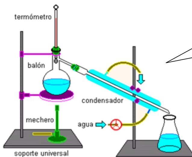
Montaje de una destilación simple
